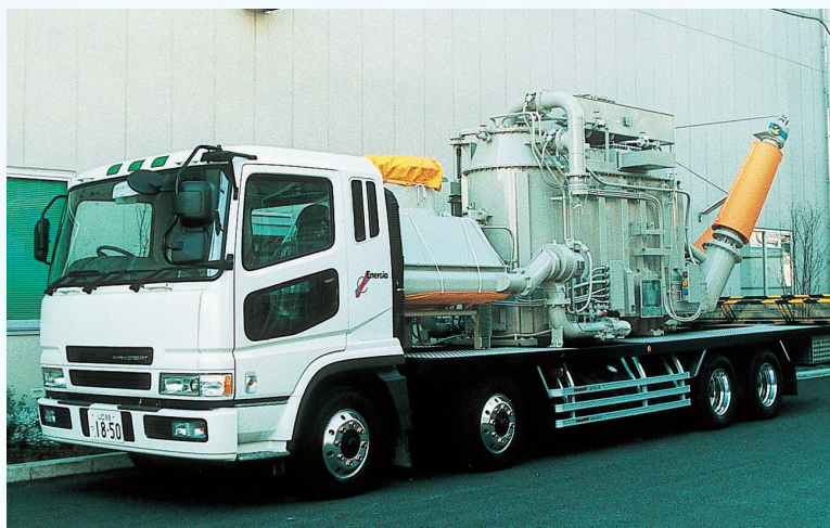
110kV 15MVA の例
