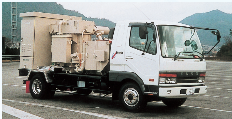
3φ 2000kVAの例
